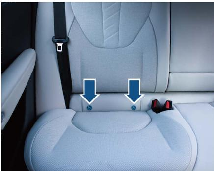
下固定锚支座位于“ISOFIX”标识两侧座椅靠背下方。请按照儿童座椅制造商提供的使用说明书安装。
