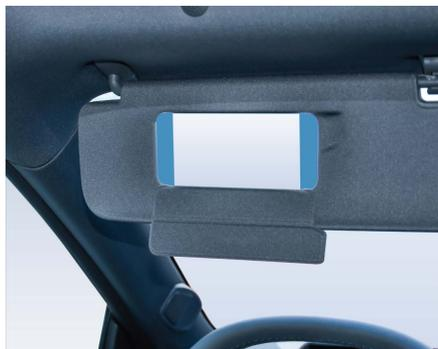
打开化妆镜盖，照明灯会自动点亮；关闭化妆镜盖时，照明灯自动熄灭。
