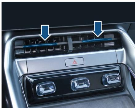
左侧中央出风口，向右侧滑动即可关闭出风口，向左侧滑动即可开启出风口。
