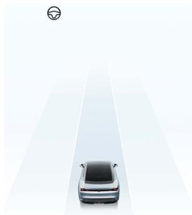
为表示车辆处于车道巡航辅助系统控制，中控屏中车道巡航辅助指示灯点亮。
