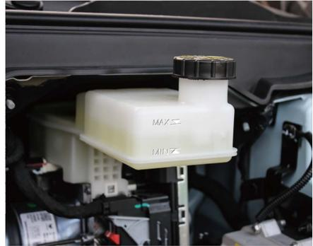
如果制动液储液壶中的制动液液位在MIN（最低）和MAX（最高）标记之间，表示制动液液位正常。反之，则表示制动液液位异常。
