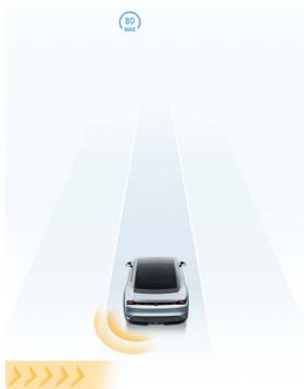
在车辆低速倒车过程中，后方横穿保护系统通过安装在车辆后部两个角雷达探测自车侧后方有横向穿行的机动车辆、摩托车或自行车快速接近自车，并存在碰撞的风险。后方横穿保护系统通过中控屏显示报警图标，并通过声音报警提示驾驶员立即采取纠正措施。
