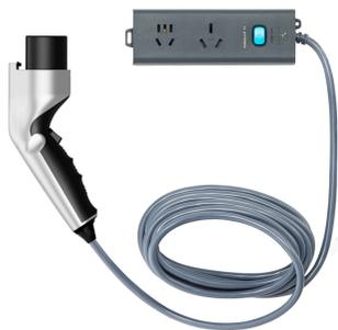
V2L放电器产品总长度为3米，配备10A+16A组合插孔方式，额定电压为220VAC/50Hz，最大放电功率为3.5kW。
