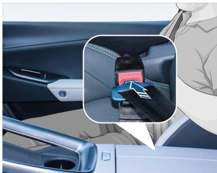
将安全带慢慢从卷收器中拉出，然后将锁舌插入带扣，直至听到“咔嗒”扣紧声，再回拉安全带确认锁止可靠。
