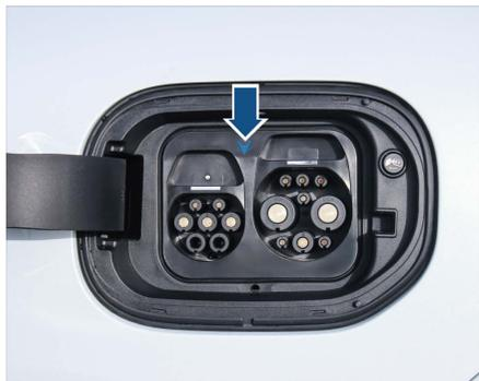
充电指示灯位于充电口旁，指示车辆充放电状态。
