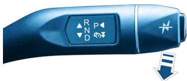
将换挡杆往D挡方向拨动一次开启自适应巡航辅助。如车速小于20km/h，则车辆会以20km/h进行巡航；如果车速大于20km/h，则车辆会以当前车速进行巡航；如本次车辆电源模式切换循环内开启过自适应巡航辅助，则以上次设定的巡航车速进行巡航。
