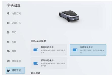
通过点击中控屏车辆设置按键
