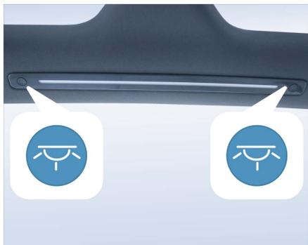
按压左侧/右侧阅读灯开关，后排阅读灯点亮；再次按压开关，阅读灯熄灭。
