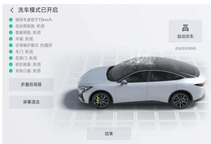
4. 在洗车模式界面可选择折叠后视镜、开启屏幕清洁模式、开启自动洗车模式。
