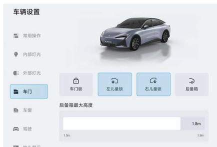
后排有儿童乘坐时，务必将儿童安全锁设置为锁止状态，此时后车门将无法从内部打开。
