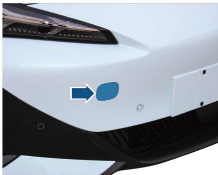
3. 将牵引环顺时针旋入螺纹孔中，并使用硬金属棒等工具将其紧固牢靠。
