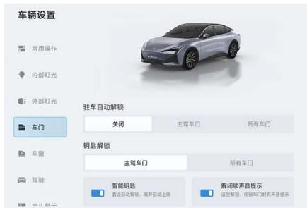
通过点击中控屏车辆设置按键
