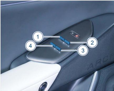
电动车窗控制开关位于驾驶员侧的车门扶手处。
