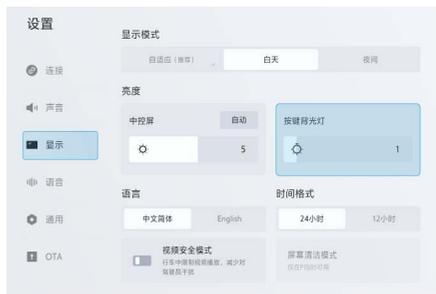
通过点击中控屏应用中心按键
