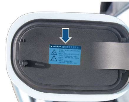
车辆充电警告标示位于车辆充电口护板内侧。
