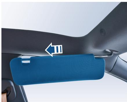
欲遮挡来自侧方的耀眼光线，可把遮阳板从内侧固定支座取下，将遮阳板转向侧窗；遮阳板遮挡侧方光源时，遮阳板有抽拉功能。
