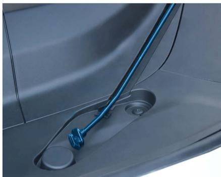
4. 将其头部卡入机舱盖上的椭圆孔中，确认可靠支撑。
