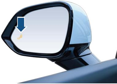
若驾驶员开启车门，开门防撞预警系统探测到与开启车门同侧相邻车道后方区域的目标与自车开启的车门存在碰撞危险时，开门防撞预警系统通过目标侧外后视镜报警灯闪烁及报警音提示驾驶员暂缓开门。
