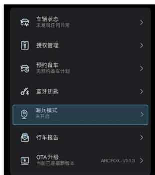
哨兵模式使用“立即开启”时，用户在离车落锁30s后哨兵模式正式启动监测；使用“预约开启”时，仅支持设置最迟次日23:59前的预约开启，若已到达开启时间但不满足开启条件会导致该次预约开启失败。
