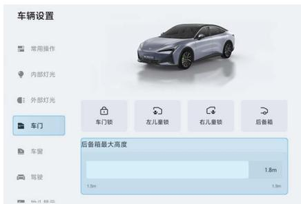
通过点击中控屏车辆设置按键 > 车门，左右滑动可对后备箱开启高度进行设定。
