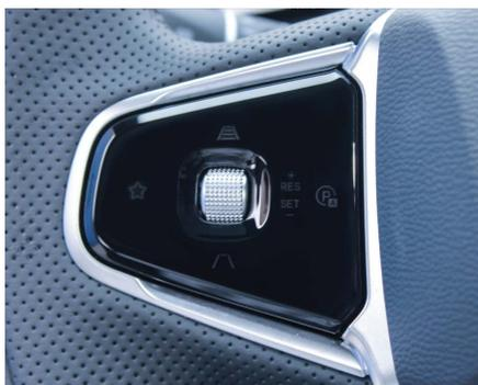
使用自适应巡航辅助控制时，如需修改设定速度，驾驶员可以通过方向盘左侧的调速滚轮（上、下滚动）或加速干预来调节目标车速。
