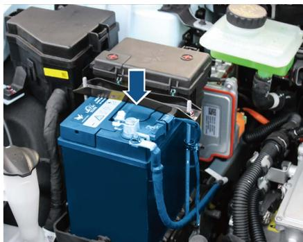
车辆蓄电池位于机舱内，请定期检查蓄电池状态，以确保固定端子无锈蚀、连接部位未松动、无裂纹等情况。
