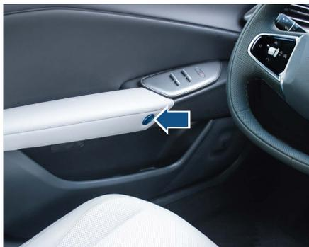
车门在闭锁状态下，连续按压两次车门开启按键，所有车门将处于解锁状态。
