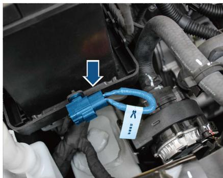
6. 断开12V蓄电池负极电缆，断开后需用保护层包裹，以免误接触而导通。
