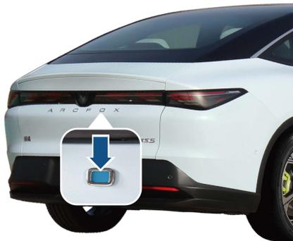
在车辆闭锁状态下，携带智能钥匙靠近后备箱并按下开启按键，即可解锁后备箱。此时向上拉起后备箱即可开启。
