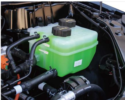
拆下机舱左侧装饰板后，可以看到空调系统冷却液膨胀罐。
