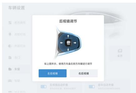
通过点击中控屏车辆设置按键 > 车窗 > 后视镜调节，可对外后视镜进行如下设置：
