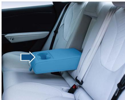
当扶手处于水平放倒状态时，扶手装备有两个杯托，可放置饮料瓶或密封型茶杯。
