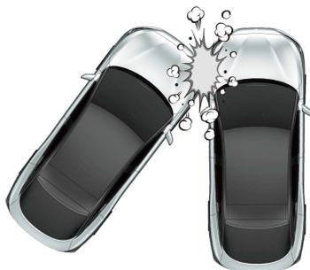
发生斜向碰撞时，气囊系统接收到的冲击能量可能不足以触发正向气囊展开，此时，正向气囊可能不展开，侧向气囊、侧向帘式气囊\*不工作。
