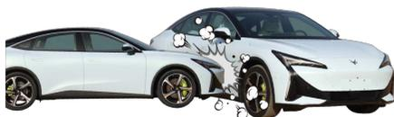
发生侧面碰撞时，驾乘人员产生侧向位移，所以从前面展开的气囊起不到对驾乘人员的保护作用，此时，正向气囊可能不展开，侧向气囊、侧向帘式气囊\*可能展开。
