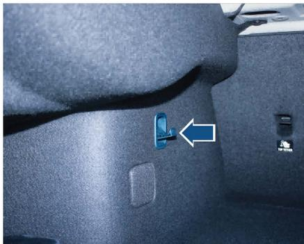
行李固定钩安装在后备箱内，用于固定松散的物品。使用时翻出挂钩并使用网类或带类物品对行李进行固定。
