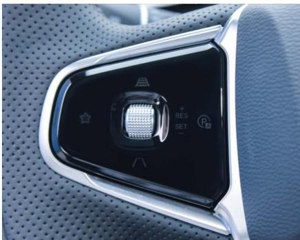
驾驶员可以按压方向盘 **RES/SET** 键，增加跟车时距；按压方向盘 **C** 键，减小跟车时距。
