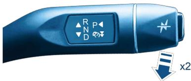
开启车道巡航辅助系统功能，需快速连续向下拨动换挡杆2次。
