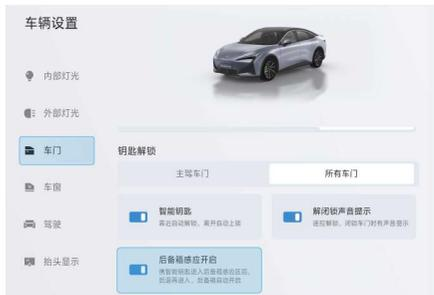
后备箱感应功能开启后（需开启智能钥匙功能），携带智能钥匙远离车辆一定距离，车辆闭锁，打开状态的后备箱将会自动关闭。
