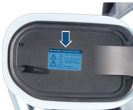
车辆充电警告标示位于车辆充电口护板内侧。
