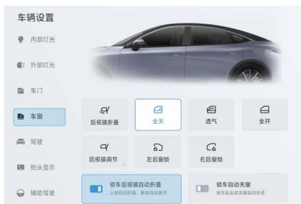
通过点击中控屏车辆设置按键 > 车窗 > 锁车后视镜自动折叠，可开启/关闭该功能。所有车门、机舱盖及后备箱关好后，按下智能钥匙闭锁键后，外后视镜自动折叠；按下智能钥匙解锁按键后，外后视镜自动展开。
