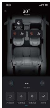
通过手机APP可远程开启座椅通风加热功能，点击对应的座椅即可开启，座椅加热支持3挡模式，点击多次可进行挡位切换。
