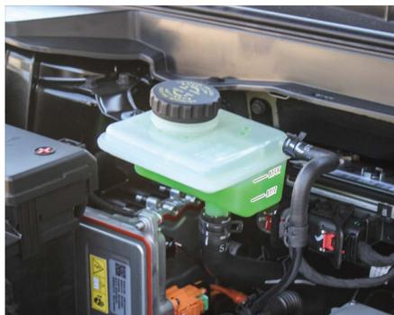
冷却液液位在MIN（最低）和MAX（最高）标记之间，表示冷却液液位正常。反之，则表示冷却液液位异常。
