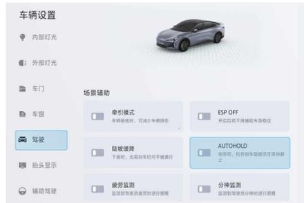
通过点击中控屏车辆设置按键 > 驾驶，开启/关闭AUTOHOLD自动驻车功能。
