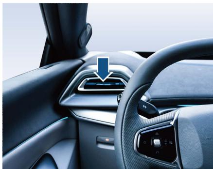
主驾左侧出风口，向右侧滑动即可开启出风口，向左侧滑动即可关闭出风口。
