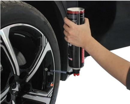
6. 待补胎液全部注入以后，将开关旋钮往“OFF”方向旋转90°，然后再从气门嘴上拧下接口，拧上气门嘴帽，然后立即行驶进行补胎。
