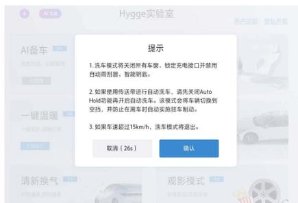
当您准备洗车时可开启洗车模式，在该模式下车辆将自动检测各部件的关闭状态，自动执行关闭车窗、空调外循环、充电口盖、智能进入功能等动作，防止车辆进水，以确保洗车过程中车辆安全。
