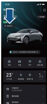
充电中心功能包括远程开启充电、远程关闭充放电、预约充电、设置充电截止电量、插枪保温、即插即充设置以及动力电池预热等功能。
