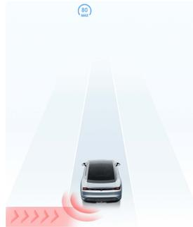
在车辆低速倒车过程中，后方横穿保护制动系统通过安装在车辆后部两个角雷达探测自车侧后方有横向穿行的机动车辆、摩托车、自行车、行人快速接近自车，并存在碰撞的风险。先由后向穿行
