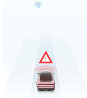
前摄像头和前雷达监测正前方道路是否有车辆、摩托车、自行车或行人等存在碰撞风险的目标。在驾驶员不立即采取纠正措施、很可能发生碰撞的情况下，前防撞预警通过中控屏显示红色目标，并通过声音报警及点刹动作警示驾驶员立即采取纠正措施。
