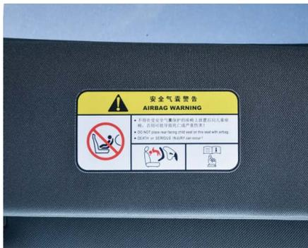
在车辆前排乘员侧的遮阳板上贴有警告标识“切勿在受正向气囊保护（激活状态下）的座位上使用后向儿童约束系统”，提醒正确安装儿童座椅。务必阅读并遵守这些标牌上的说明。
