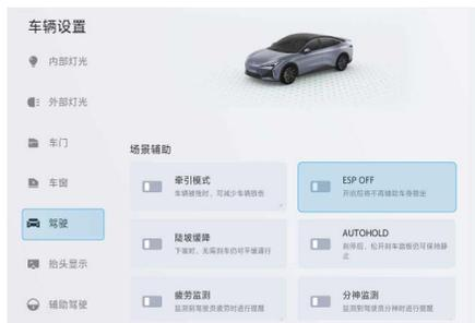
通过点击中控屏车辆设置按钮 > 驾驶，开启/关闭ESP OFF功能。
