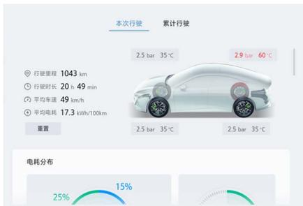
轮胎信息显示轮胎的压力和温度。正常情况下中控屏内的胎压信息显示白色，当轮胎气压、温度出现异常时，中控屏内的胎压监测报警灯点亮，并伴有提示音，中控屏内对应的故障轮胎胎压信息显示红色。
