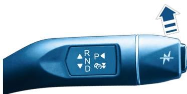
如需取消自适应巡航辅助时，驾驶员将换挡杆往R挡方向拨动一下或踩刹车退出自适应巡航辅助。
