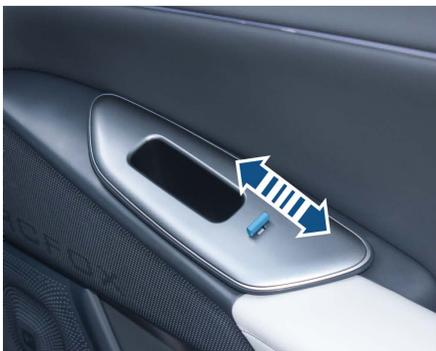
乘员侧车窗玻璃升降开关位于各车门扶手上，操作方法与驾驶员侧车窗相同。
