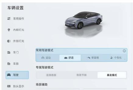
通过点击中控屏车辆设置按键 > 驾驶，可对所需的常用驾驶模式进行选择。车辆初次上电时默认为舒适模式，重新上电后，驾驶模式为最近一次设置状态。
