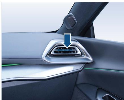
副驾右侧出风口，向右侧滑动即可关闭出风口，向左侧滑动即可开启出风口。
