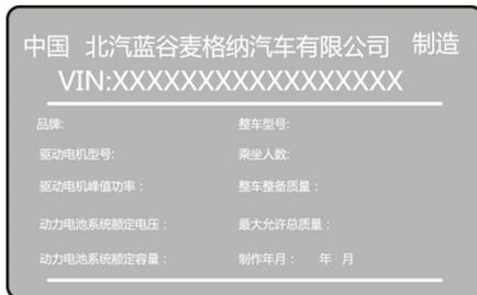
出厂铭牌位于右侧B柱下端，车辆型号、车辆识别码等信息，都标在出厂铭牌上。
