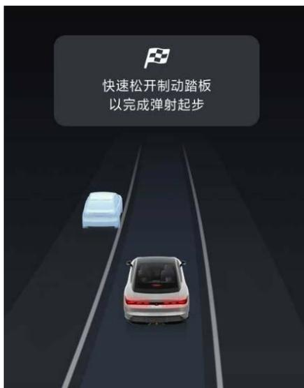
5. 此时，驾驶员左脚松开制动踏板完成弹射起步。
