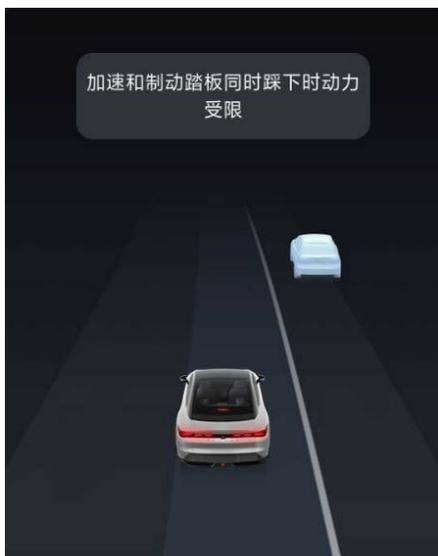
辆为READY且无故障状态，驾驶员控制车辆挡位进入D挡或者R挡，在行车过程（车辆有车速时）中驾驶员双踩油门和制动踏板时，中控屏显示“加速和制动踏板同时踩下时动力受限”的文字提示，提醒用户谨慎驾驶。
