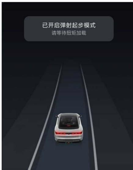
4. 待电机扭矩加载完成后，中控屏会提示用户：快速松开制动踏板，以完成弹射起步，并伴有提示音。
