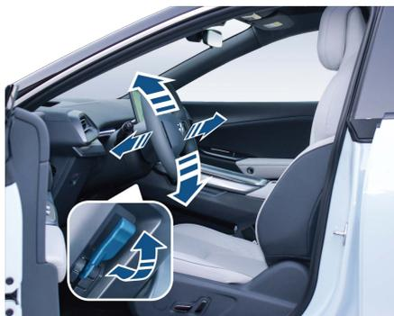
在车辆静止状态下，可通过下列方式进行方向盘位置调节。
