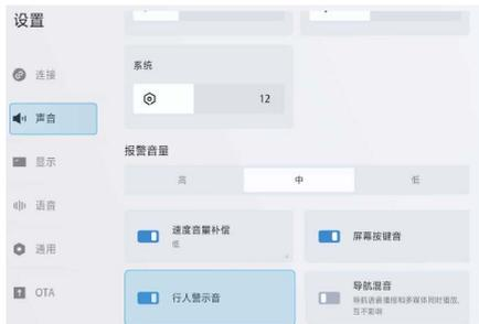
通过点击中控屏应用中心按键
