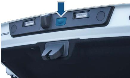
将后备箱的开启高度调节至理想位置，按压后备箱内侧开关并保持3s以上，后备箱开启高度设定完成。
