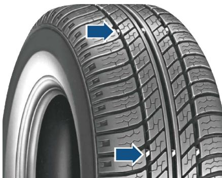
不合适的轮胎压力将导致轮胎胎面异常磨损。通过轮胎上的磨损标记，可检查轮胎的磨损状况。
