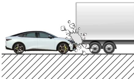
与大型货车发生追尾碰撞事故时，驾驶员本能地进行紧急制动，这时发生车体前部下沉。由于大型货车离地间隙较高，车辆前部会钻到货车底部，车辆前部的溃缩变形会吸收撞击能量，碰撞减速速度未达到气囊展开条件，此时，正向
