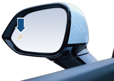
若驾驶员未开启转向灯，变道预警系统探测到相邻车道后方区域的目标与自车存在碰撞危险时，变道预警系统通过目标侧外后视镜报警灯常亮提示驾驶员变道风险。
