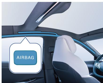
侧向帘式气囊位于车顶两侧A柱、B柱与C柱之间沿车顶边缘的位置内。
