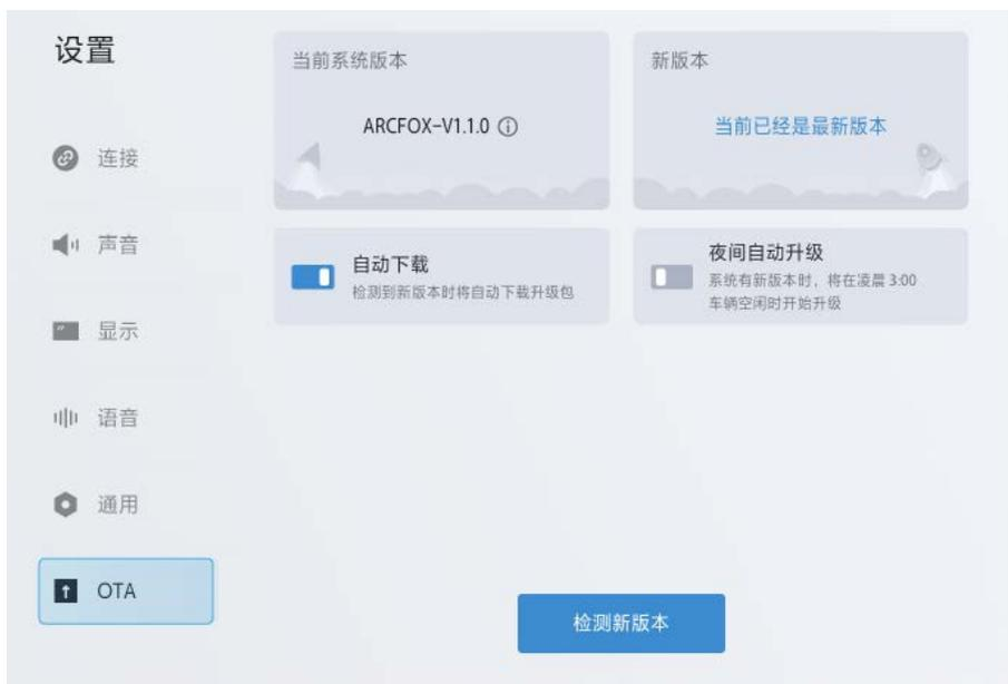
车辆支持移动通讯网络进行软件升级，为车辆提供最新功能。当您收到新版本升级提示时，建议您尽快安装可用的软件升级。
