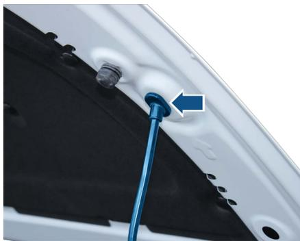
4. 拆下机舱内饰板（拆卸方法请联系ARCFOX授权经销商）。
