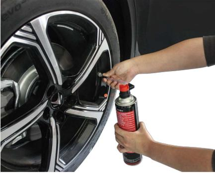
5. 单手垂直把持罐体，另一手将开关旋钮向“ON”方向旋转90°，充气补胎液即开始自动向轮胎内充填，充填完毕后，如有充气补胎液溢出，可迅速将其冲洗掉。
