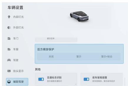
通过点击中控屏车辆设置按键
