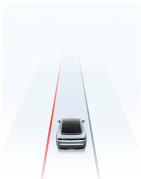
设置警示后，车辆无意识偏离原车道时，车道辅助系统仅根据驾驶员设置的报警类型进行报警提示，不会主动纠正方向盘确保车辆回到原车道内。设置纠偏、警示+纠偏后，车辆偏离原车道时，车道辅助系统根据驾驶员设置的报警类型进行报警提示，若驾驶员未有效控制转向，车道辅助系统会主动纠正方向盘确保车辆回到原车道内。
