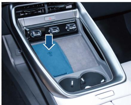
无线充电器位于中控台上，通过线圈将电能以电磁波感应原理传输给手机电池。使手机在不需要导线连接的条件下进行充电。
