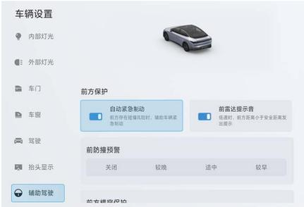
通过点击中控屏车辆设置按键
