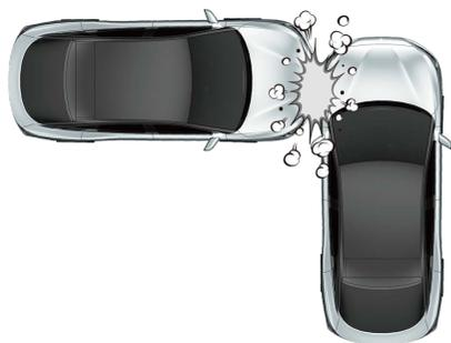
乘员车箱以外的侧面受到撞击时，车身受到微弱的碰撞，正向气囊、侧向气囊、侧向帘式气囊\*不工作。
