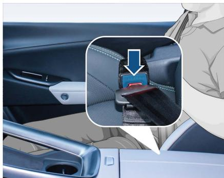
按下带扣上的红色按键，即可解除安全带锁止。解锁安全带后，将安全带适当向上固定点方向推送，安全带将自动收回卷收器中。
