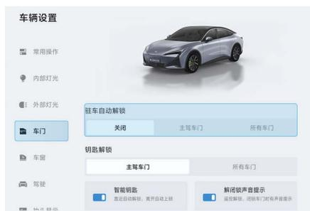
通过点击中控屏车辆设置按键 > 车门，可对驻车自动解锁功能进行如下设置：
