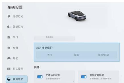
通过点击中控屏车辆设置按键
