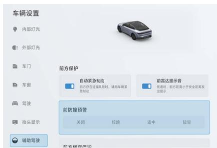
通过点击中控屏车辆设置按键 > 驾驶辅助。可开启/关闭前防撞预警。可根据选择的灵敏度高/低界定驾驶功能早晚触发。
