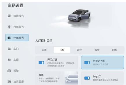
通过点击中控屏车辆设置按键 > 外部灯光。可开启/关闭智能远光灯功能。
